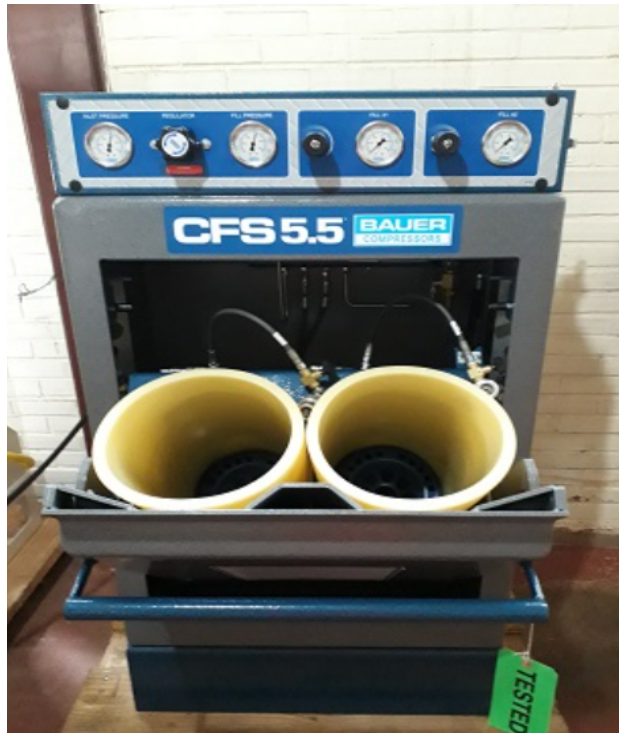
Figura 2 – Caixa de armazenamento para recarga de cilindros
