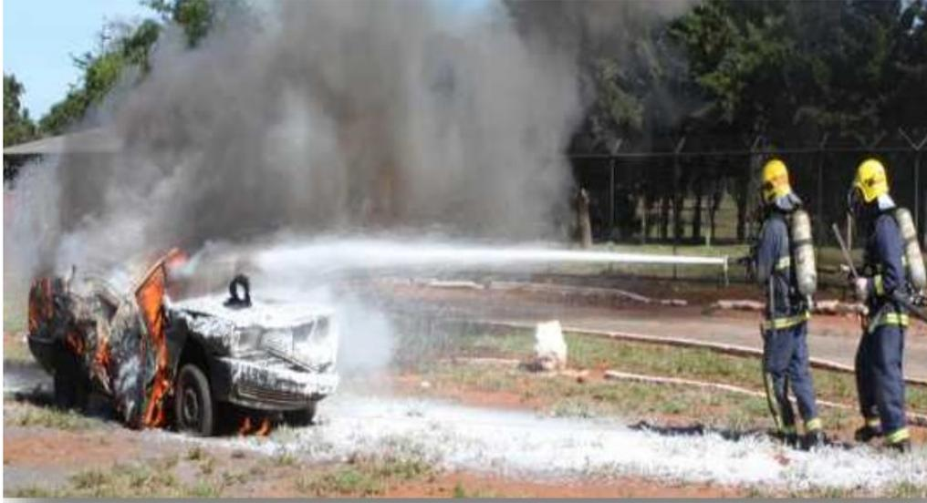
**Figura 3: Combate com uso de espuma molhada.**
