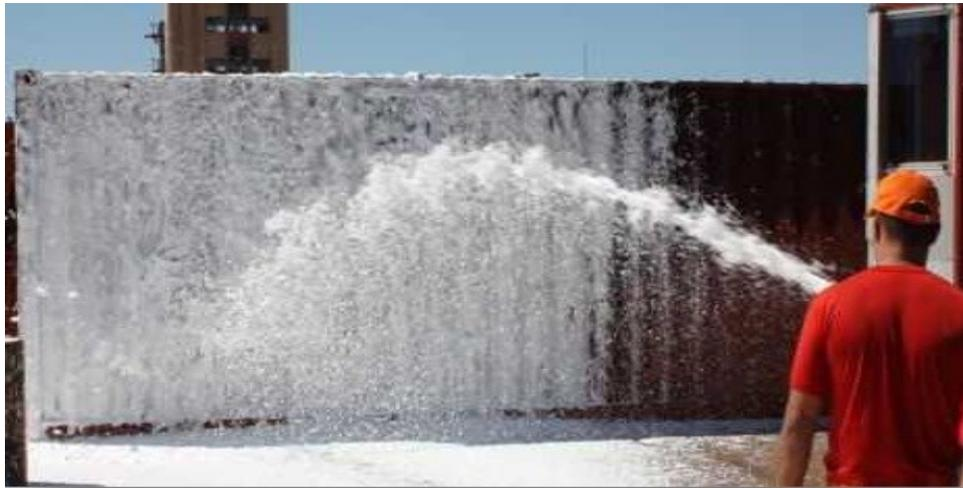
**Figura 4: Aplicação de espuma seca em estruturas.**
