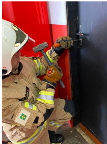
Figura 12: Utilização de chave de fenda como punção em um miolo não saliente.
