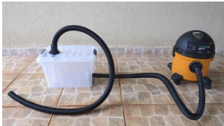
Figura 4 – Dispositivo adaptado de aspiração de abelhas.
