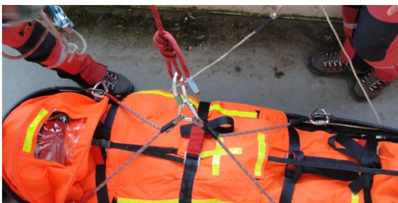
Figura 13 – Maca rígida com cobertura de proteção para vítima e sistema de suspensão fixo com região dos pés aberta
