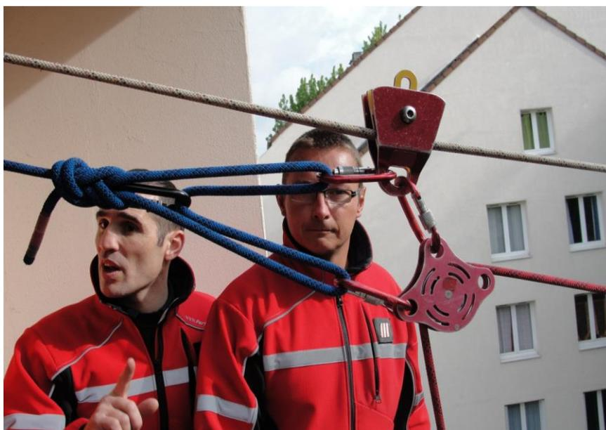
Figura 14 - Sistema de movimentação e de suspensão da maca
