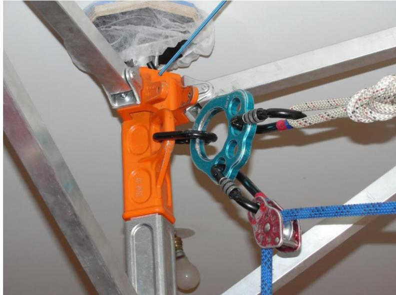
Figura 10 - Ponto de ancoragem do SIAM com a placa de ancoragem e a corda da tirolesa
