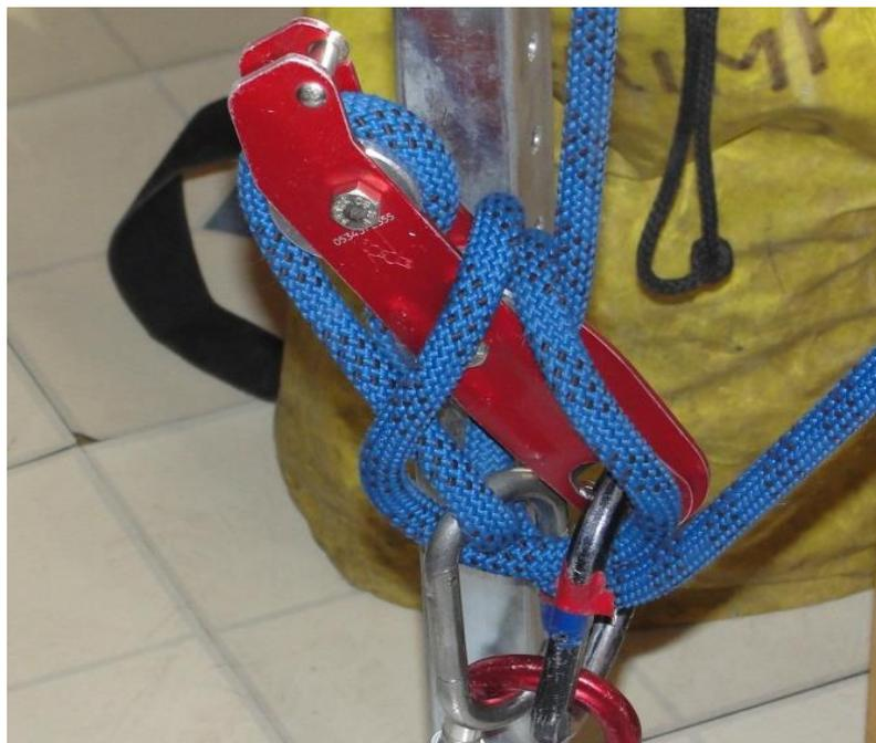
Figura 11 – Sistema de descida da maca com descensor *dressler* simples na base do SIAM
