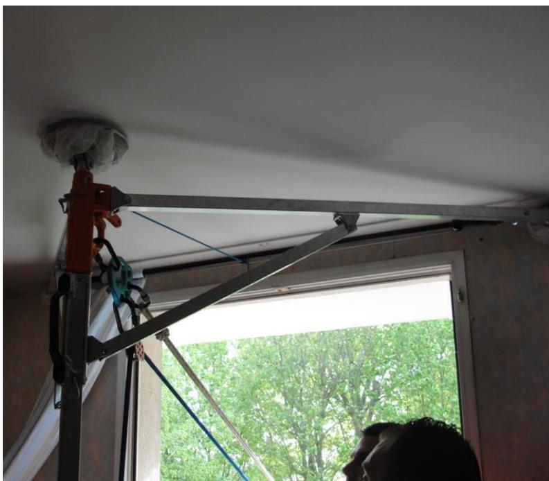
Figura 9 – Parte superior do SIAM com ponto de ancoragem da tirolesa e do sistema de descida
