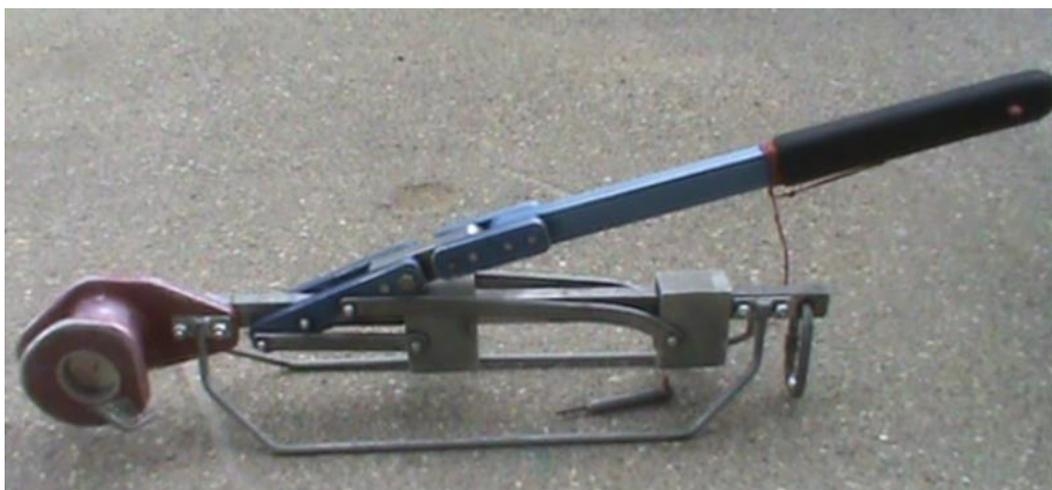
Figura 7 – Guincho de alavanca para cordas EVAK500®
