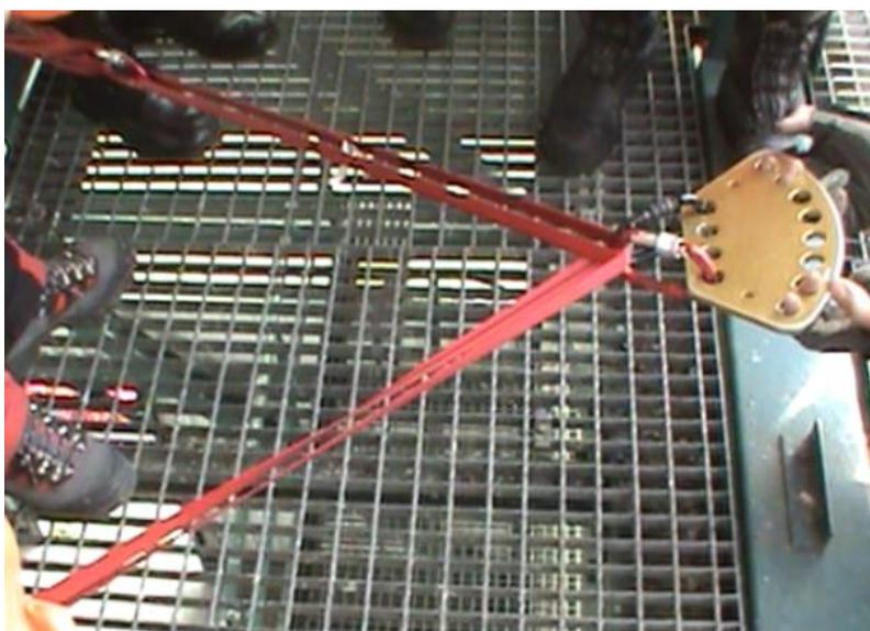
Figura 8 – Ancoragem distribuída da placa de ancoragem
