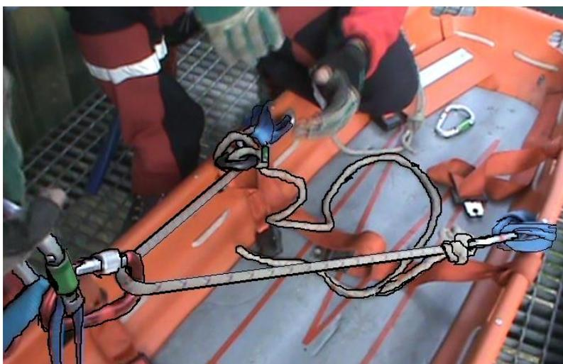
Figura 11 – STEF com regulagem no freio do tipo oito
