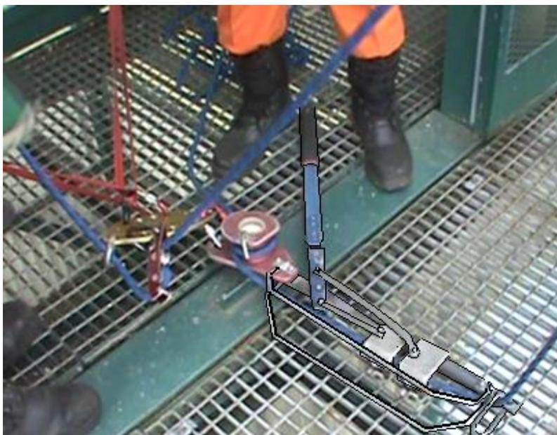
Figura 9 – Conexão do guincho EVAK500 e do descensor *dressler* Simples na placa de ancoragem
