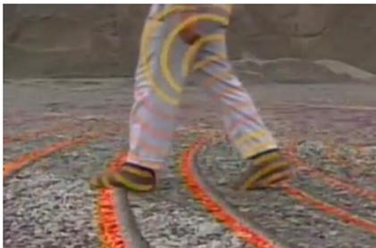
Figura 4 - Circulação de energia entre as pernas em razão da diferença de potencial em um local energizado
