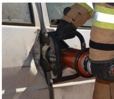
Figura 14 - Uso de alargador para criar espaço para inserção das lâminas do cortador
