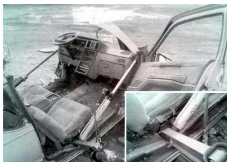
Figura 34 - Rebatimento de painel com uso de alargador para apoiar a base do extensor
