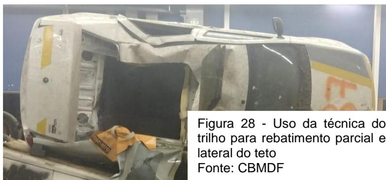
Figura 28 - Uso da técnica do trilho para rebatimento parcial e lateral do teto
