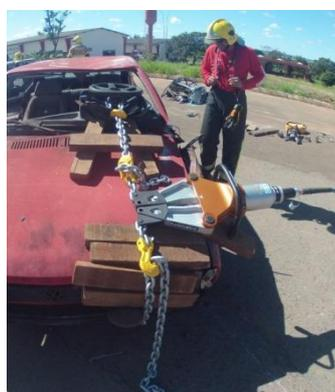
Figura 4 - Elevação de volante com o uso de correntes e alargador
