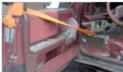
Figura 1 - Afastamento de pedal com uso de fita tubular
