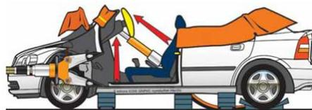
Figura 36 - Combinação de extensor e alargador para execução de levantamento de painel
