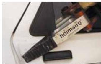
Figura 12 - Criação de ponto de apoio para o alargador
