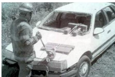
Figura 5 - Elevação de volante com o uso de guincho de alavanca
