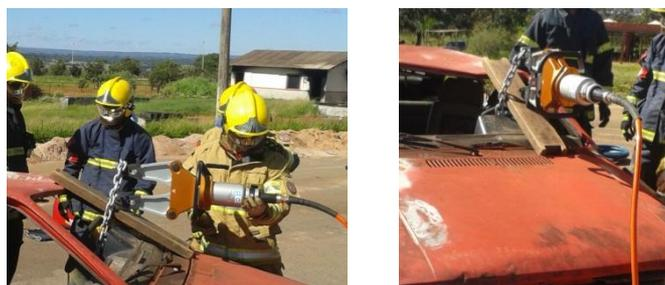
Figura 3 - Elevação de volante com o uso de correntes e alargador
