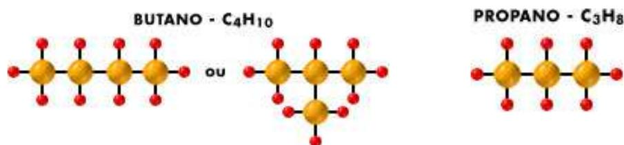
Figura 26 - Figura de moléculas de butano e propano
