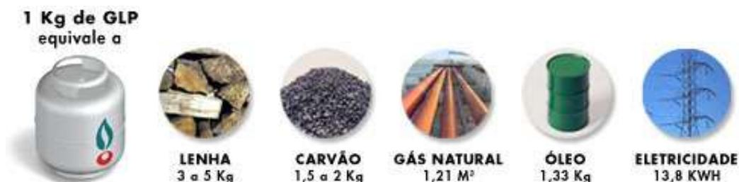
Figura 27 - Equivalência do poder calorífico do GLP
