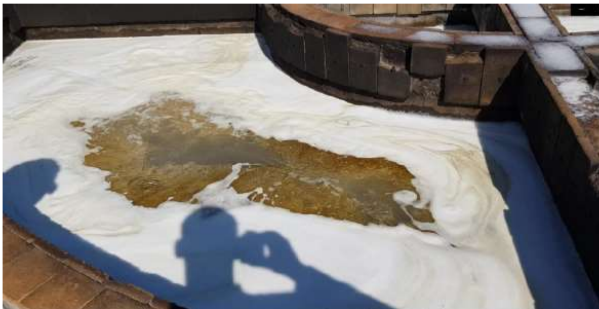
Figura 3 – Decomposição do LGE - CBMDF pelo contato com a gasolina
