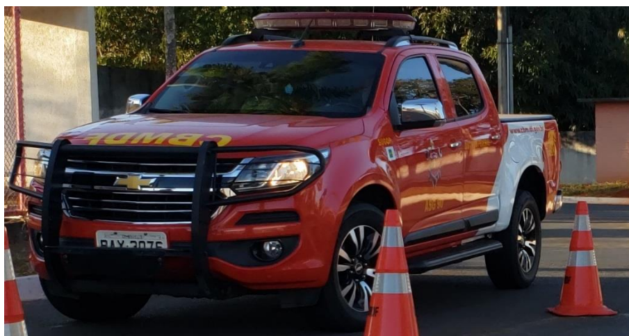
Figura 4 – Guarda-mato obstruindo a placa da viatura
