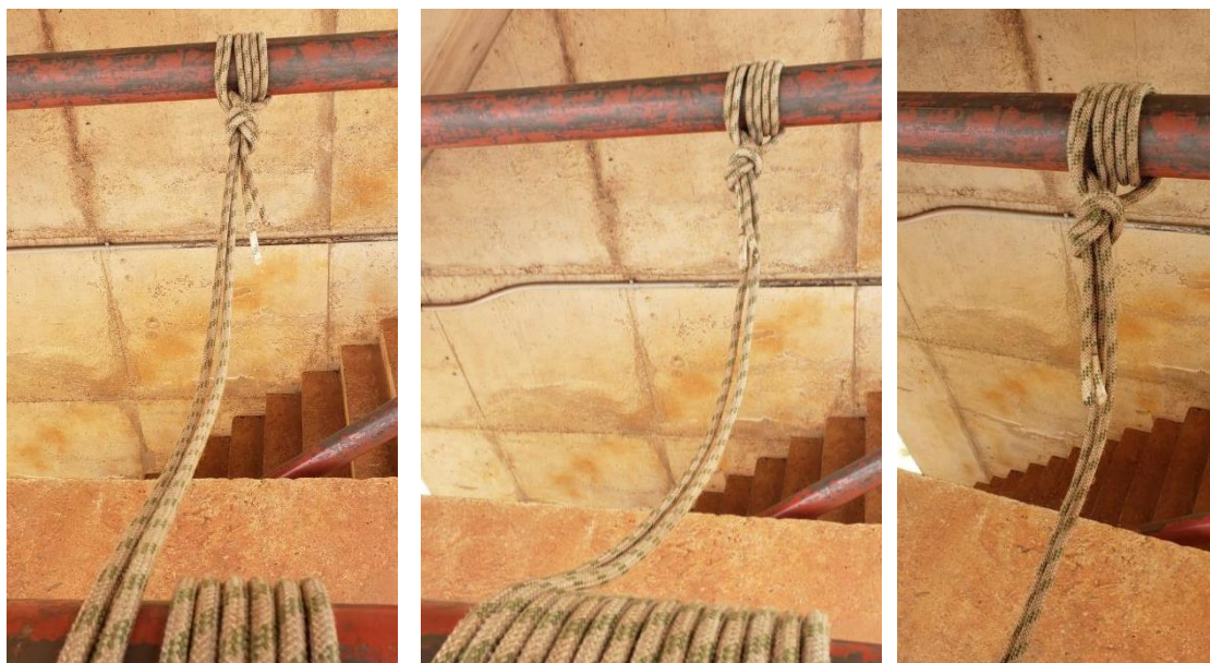
Figura 3 – Ancoragem secundária direta na Torre Auxiliar
