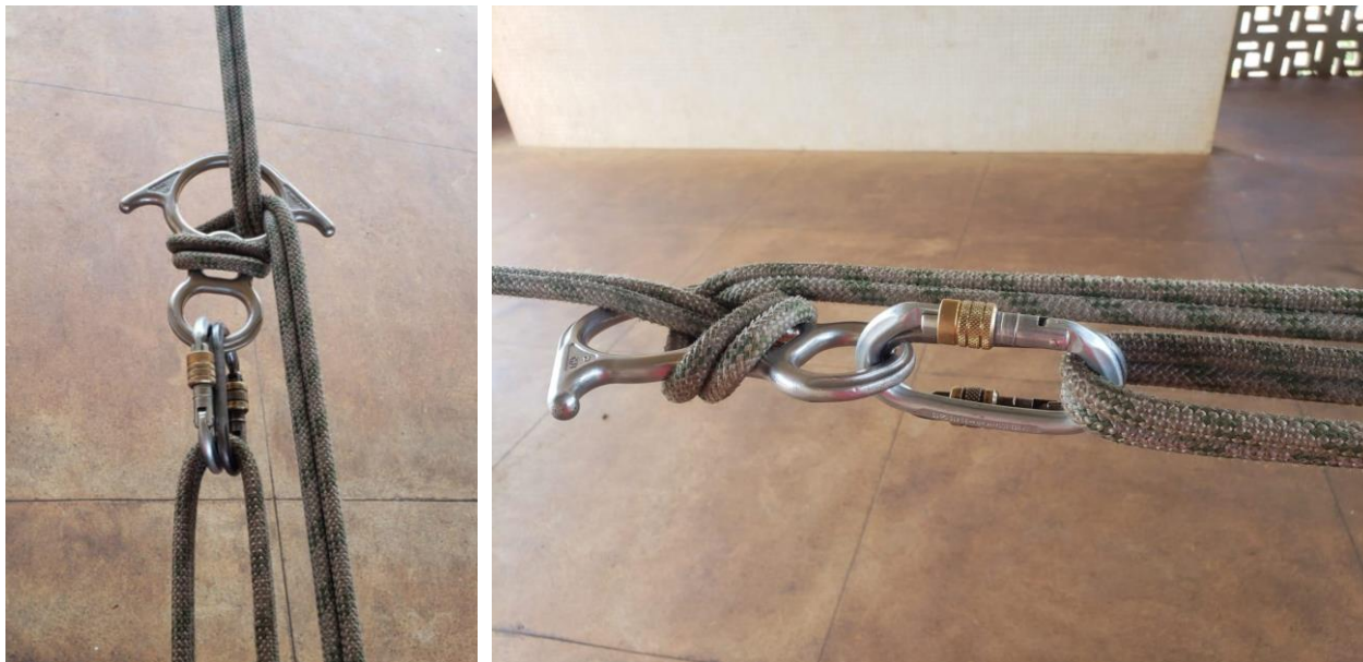
Figura 9 – Freio oito de resgate na Torre Principal
