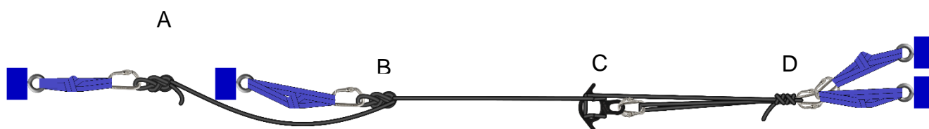
Figura 13 – Tirolesa com corda permeada ou dupla com ancoragem indireta
