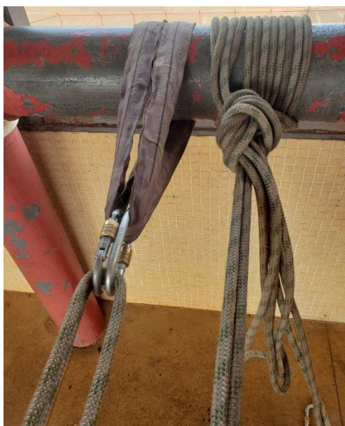
Figura 8 – Finalização com fiel reforçado
