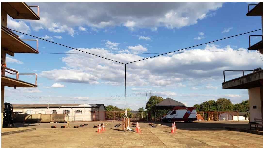
Figura 20 – Catenária na corda de 11 mm na técnica do Contrapeso
