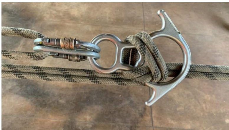
Figura 13 – Freio oito de resgate na Torre Principal
