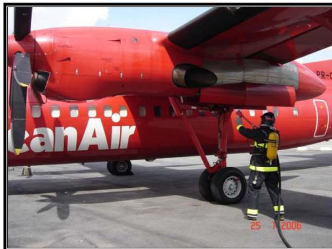
Figuras 12 – Combate a incêndio em motores convencionais.
