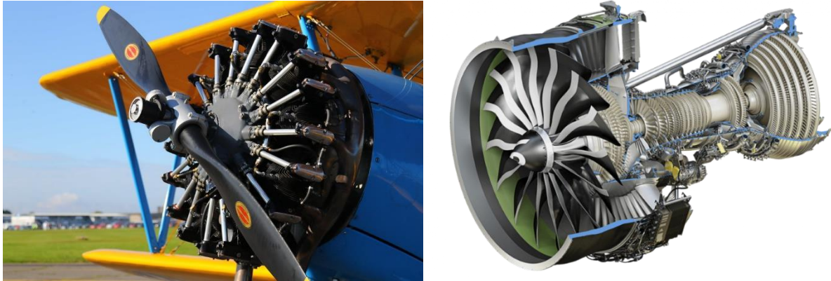
Figura 5 – Motores a Pistão e Turbojato
