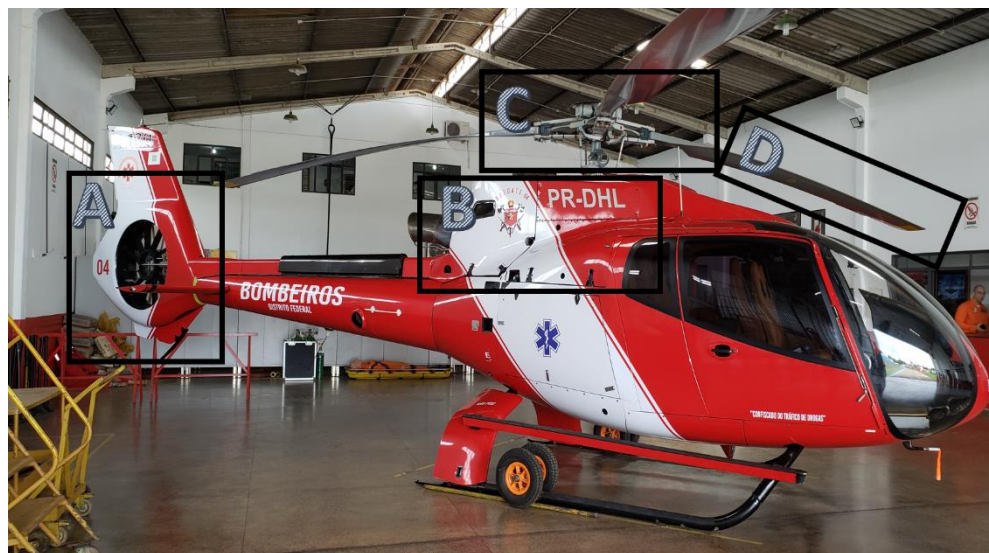
Figura 2. Partes fundamentais de uma aeronave de asa rotativa
