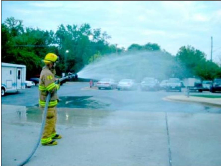
Figura 6 – Fluxo de mangueira de névoa média e baixa pressão
