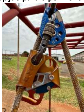
Figura 6 – Melhor opção para o polifreno (Polia AR35 e Basic)
