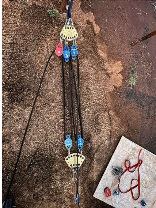
Figura 18 – Sistema 10:1 para elevação da carga
