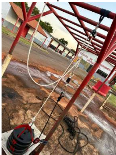
Figura 1 – Sistema 1:1 isolado para mensurar a perda de carga
