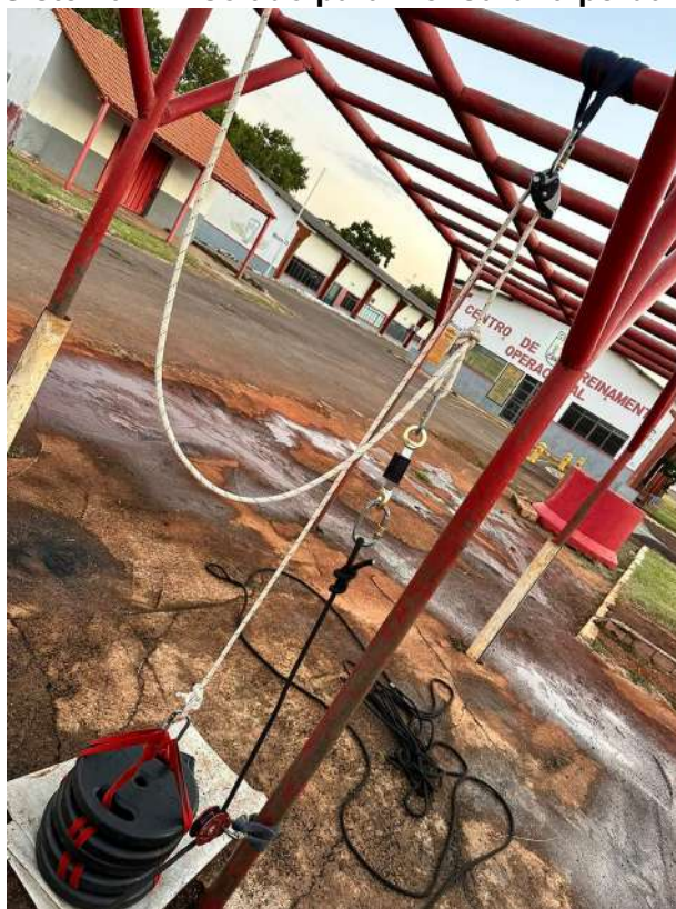
Figura 17 – Sistema 1:1 isolado para mensurar a perda de eficiência
