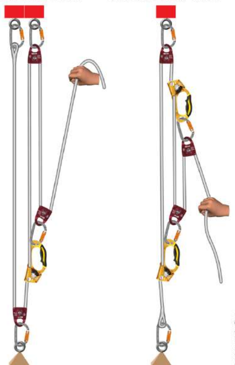
Figura 14 – Exemplo de sistemas composto e complexo
