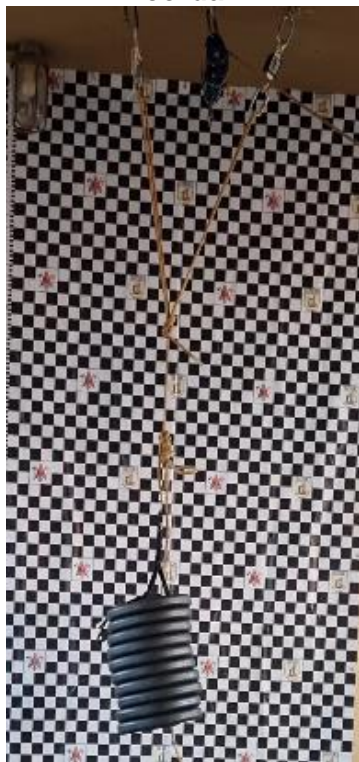
Figura 19 – Ancoragem equalizada com corda
