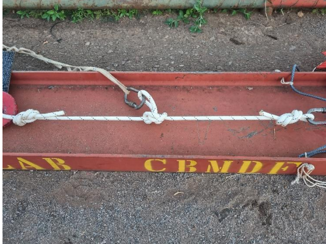
Figura 7 – Nó borboleta tracionado pelos chicotes
