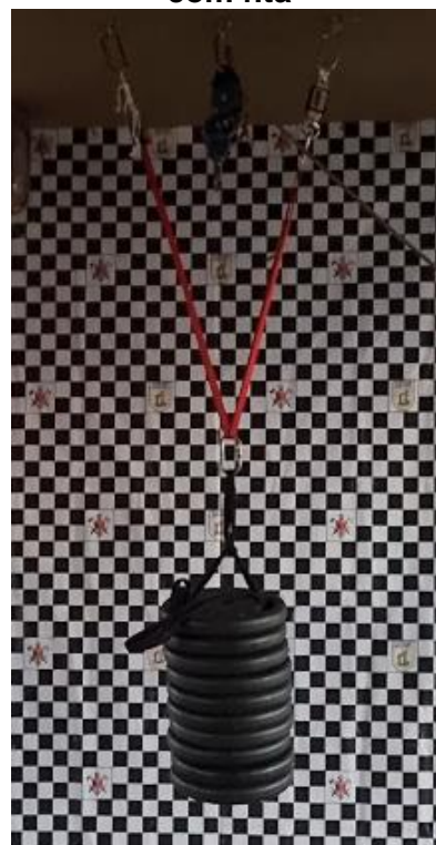
Figura 18 – Ancoragem equalizável com fita
