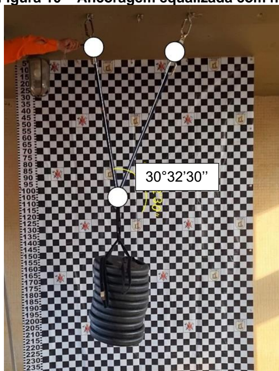
Figura 10 – Ancoragem equalizada com fita
