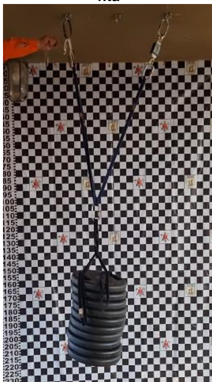
Figura 17 – Ancoragem equalizada com fita
