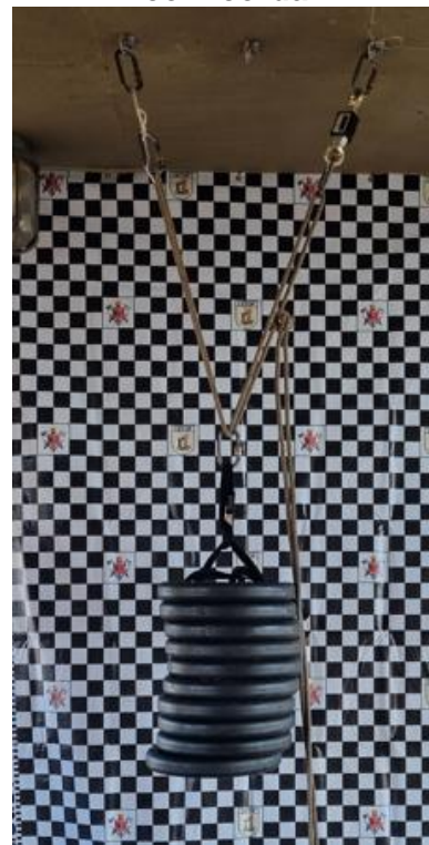
Figura 20 – Ancoragem equalizável com corda
