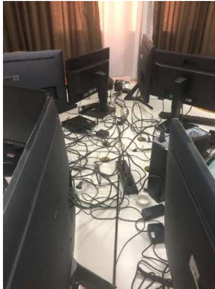
Figura 24 – Computadores ligados em um único ponto de energia elétrica
