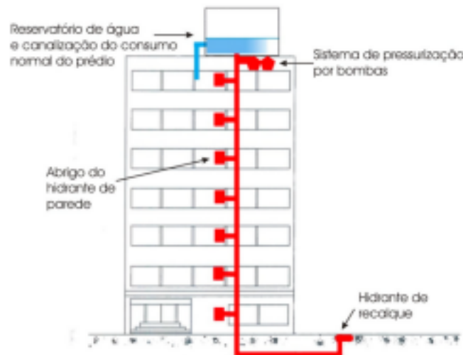
Figura 7 - Esquema vertical do Sistema de hidrante de parede
