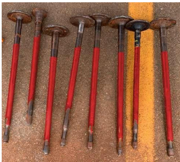
Figura 17 - Pintura das pontas de eixo com "área de alerta" a ser fincada no solo
