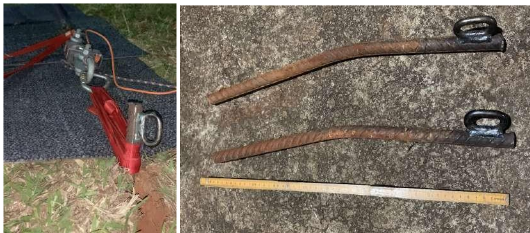
Figura 18 - Vergalhões de 3/4" não resistiram ao serem tracionados e deformaram
