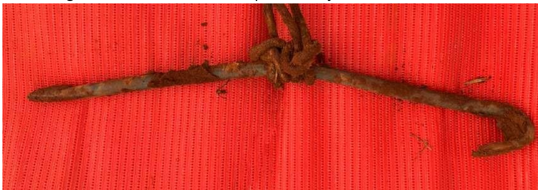
Figura 6 - Alavanca danificada após amarração no centro na alavanca
