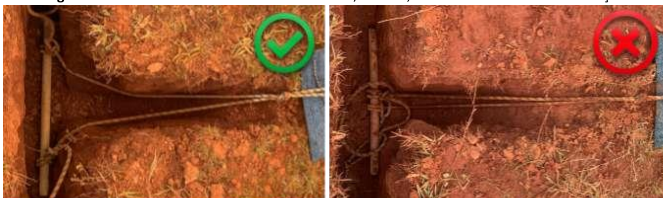
Figura 7 - Alavanca horizontal com madeira de 3,5x60cm, variando-se o local de amarração
