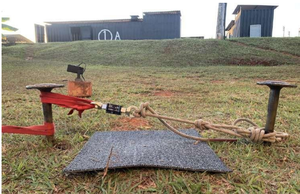
Figura 22 - Estacas com 2 pontas de eixo em Linha Instrumentalizada
