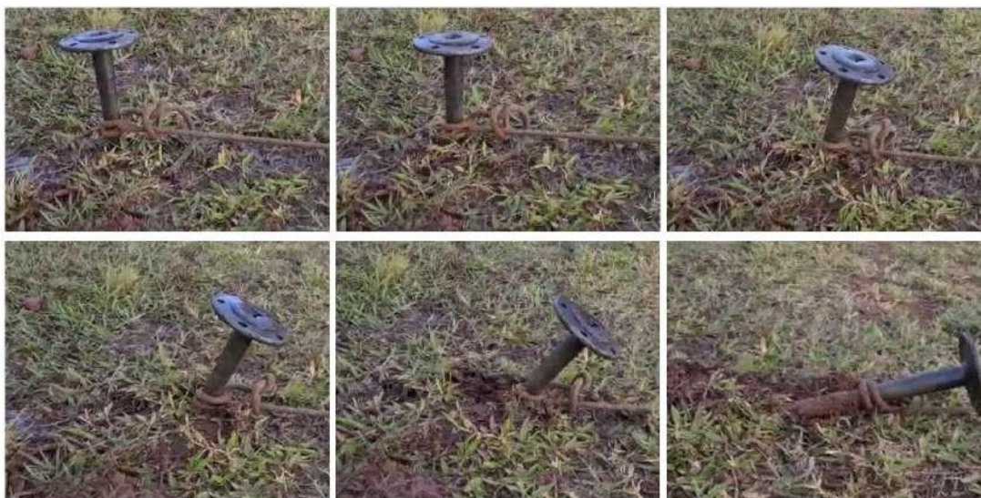
Figura 14 - Sequência de arrancamento de estaca vertical simples.
