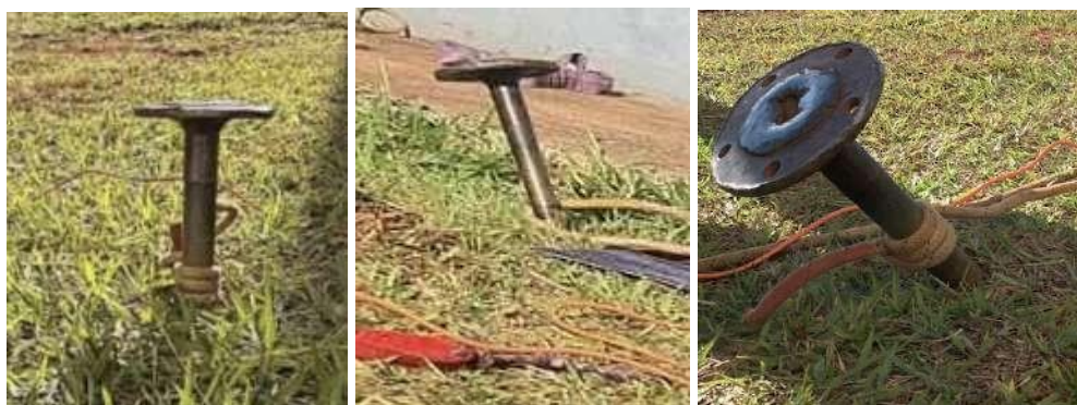
Figura 13 - Estaca Vertical com 0°, 15° e 30° de inclinação.
