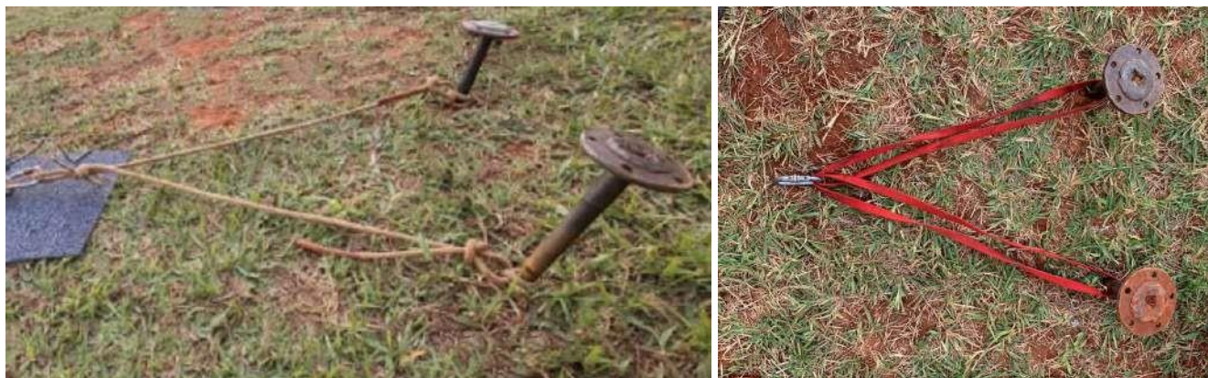
Figura 11 - Estaca Vertical com 2 pontas de eixo em paralelo
