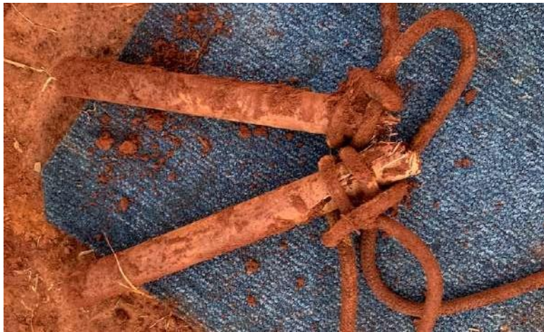
Figura 8 - Alavanca horizontal com madeira de 3,5x60cm, partida com amarração ao centro
