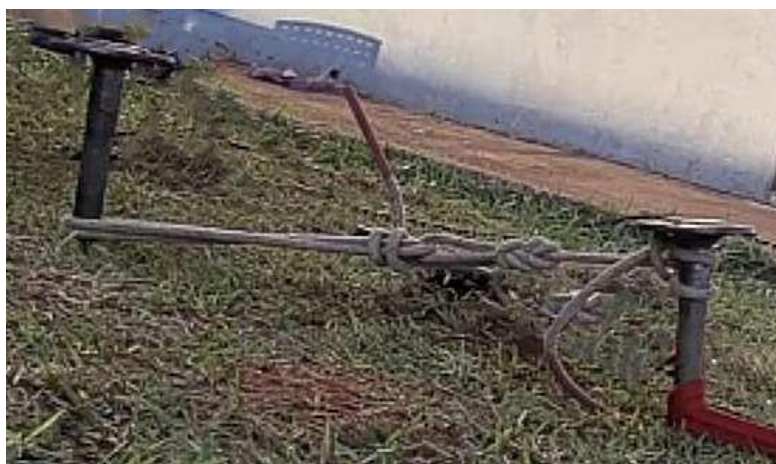
Figura 10 - Estaca Vertical com 2 pontas de eixo em linha
