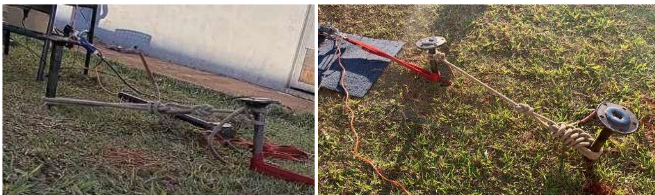
Figura 21 - Estacas Vertical com 2 Pontas de Eixo em Linha
