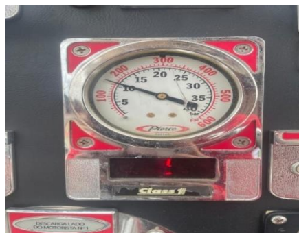
Figura 25 – Viatura a 11 bar
