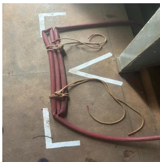
Figura 28 – Sistema com 1 dobra de 130°
