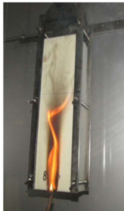
Figura 2. Representação do ensaio de ignitabilidade
