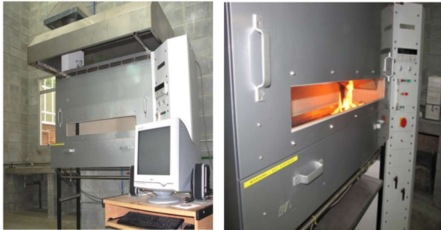
Figura 5. Representação do ensaio de determinação do comportamento em relação à queima de pisos, utilizando uma fonte de energia radiante
