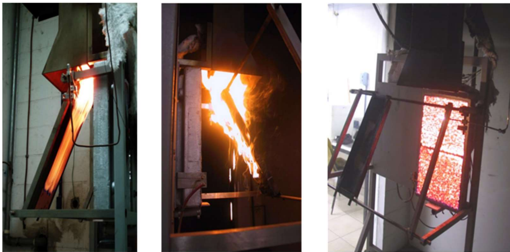
Figura 3. Representação do ensaio de determinação do índice de propagação superficial de chama pelo método do painel radiante
