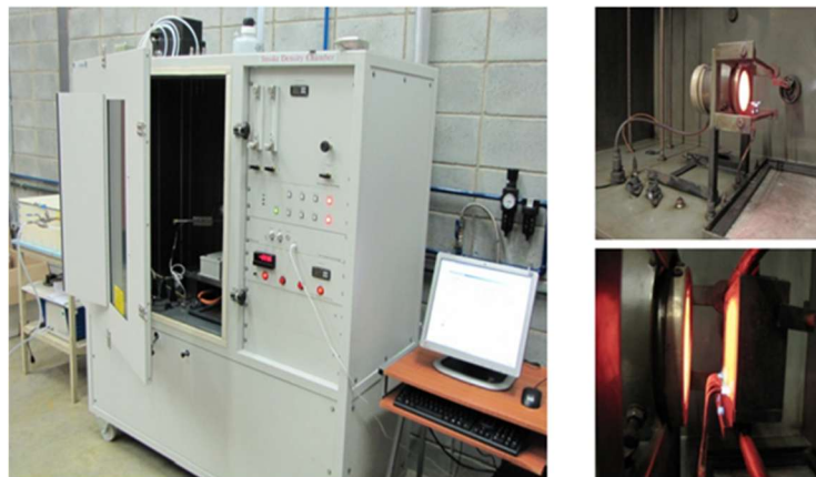
Figura 4. Representação do ensaio de determinação da densidade óptica específica de fumaça gerada por materiais sólidos
