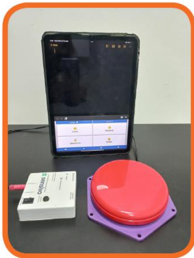
Figura 3 – Aplicativo para tablet com rastreo, fixação do olhar e emissão de voz.
