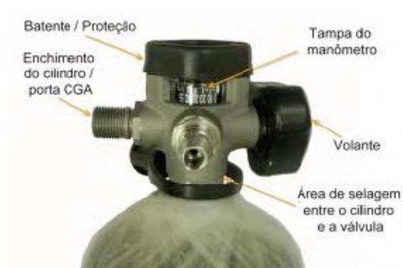
Fonte: *Scott Safety Air – Pak (Série NxG) Conjunto Válvula e Cilindro (2012).*
