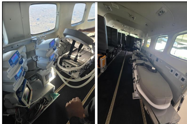
Figura 6 – Configuração para transporte aeromédico de paciente na maca
