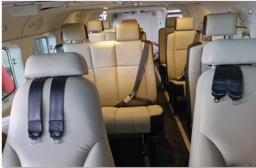
Figura 4 – Configuração interna do Grand Caravan para transporte de pessoal
