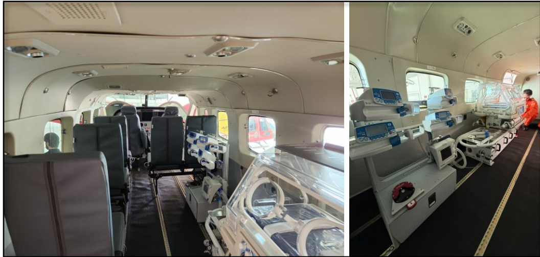
Figura 7 – Configuração para transporte aeromédico de paciente em incubadora
