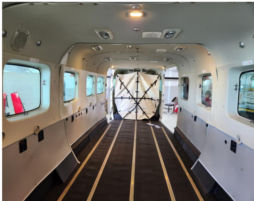
Figura 5 – Configuração interna do Grand Caravan para transporte de carga
