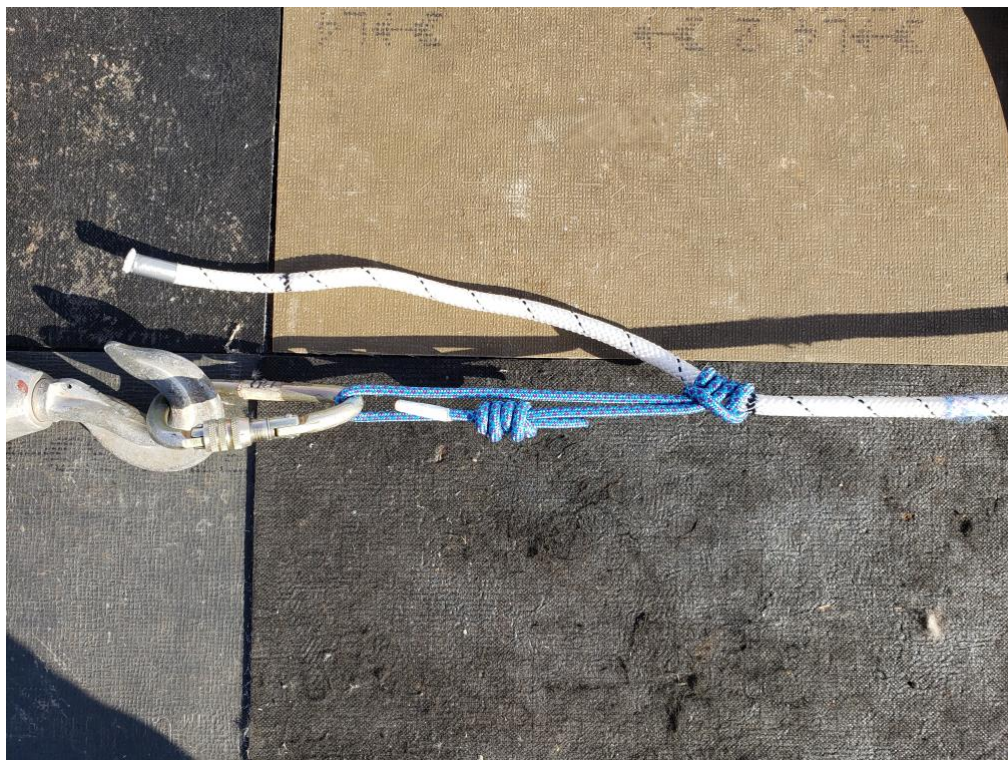
Figura 2. Amostra do nó prussik a 4 voltas.
