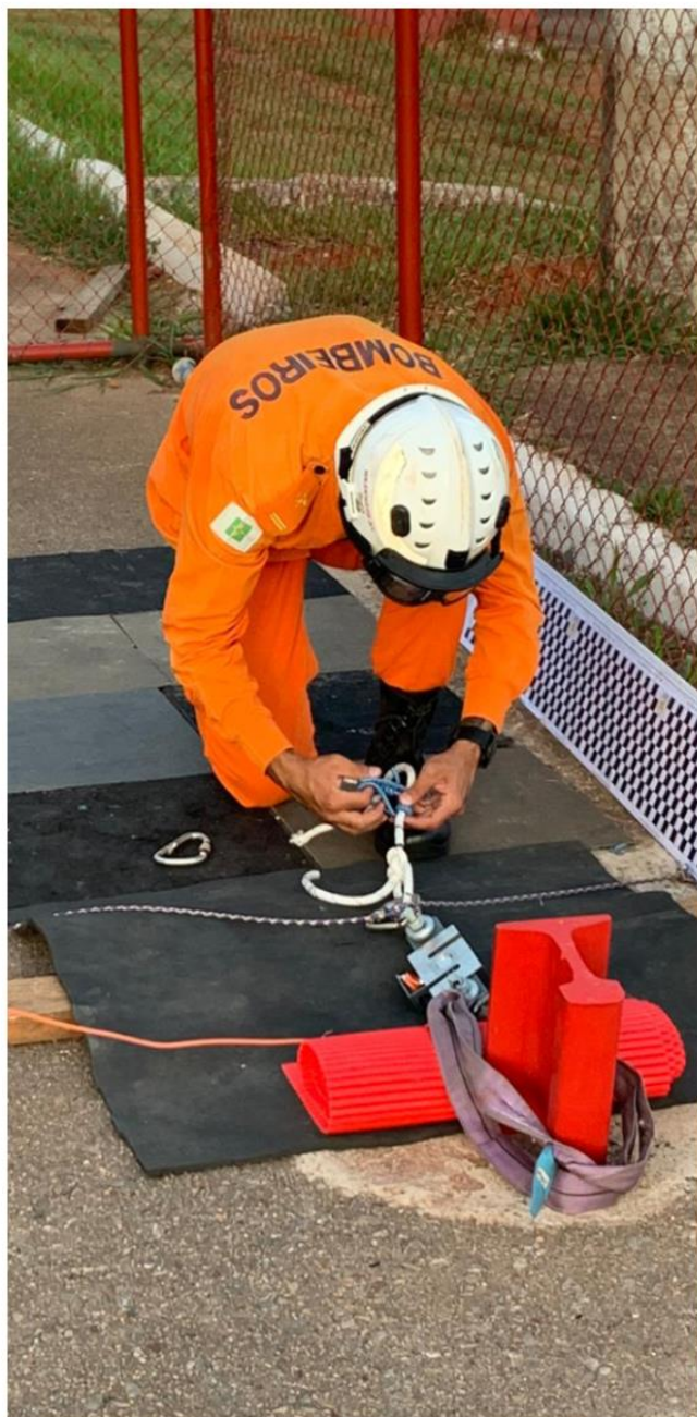
Figura 34. Montagem de amostra para testes e base utilizada para testes e manopla de acionamento remoto do guincho de tração.
