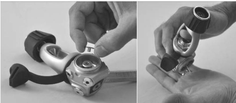
8. Use uma chave Allen de 8 mm para remover o bujão (129604/129709/129746). Vire o corpo para permitir que a mola (122244) e o assento de HP (124624) caiam na palma da mão. Separe a mola e o assento da HP.
