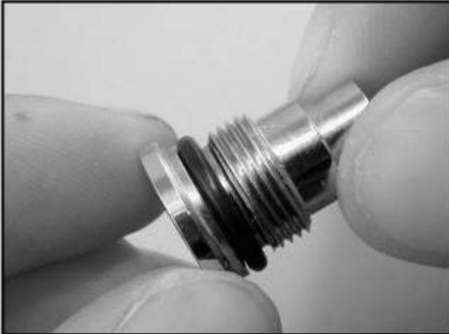
5. Coloque um novo assento HP (124624), com a face azul voltada para o interior do corpo. Verifique se o assento está ereto dentro do corpo. Posicione a mola (122244) ao redor do assento.
