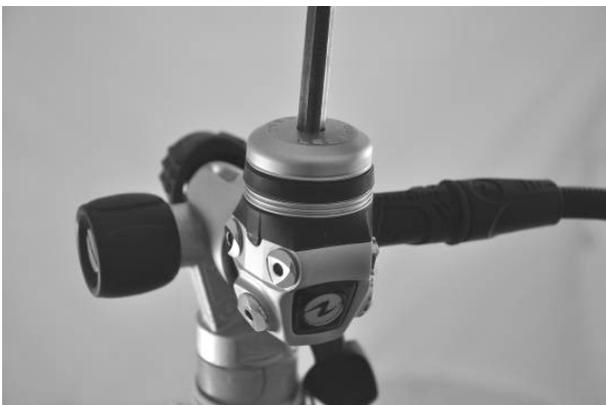
4. Feche a válvula do cilindro e purgue o regulador. Remova o medidor de IP e encaixe o bujão de IP.
