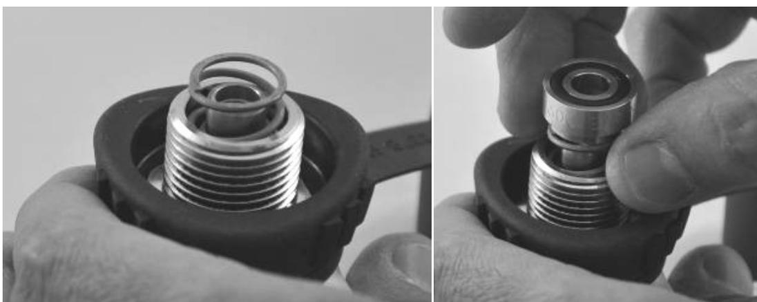
g. Parafuse um adaptador Yoke ao volante DIN para comprimir o conjunto.
