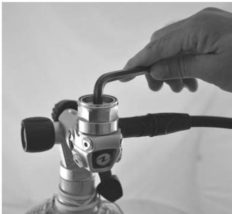
Gire o parafuso em incrementos de 1/8 de volta e purgue o regulador várias vezes, usando o segundo estágio, após cada incremento. Ajuste o MP da seguinte maneira: IP a 8,5 bar.
