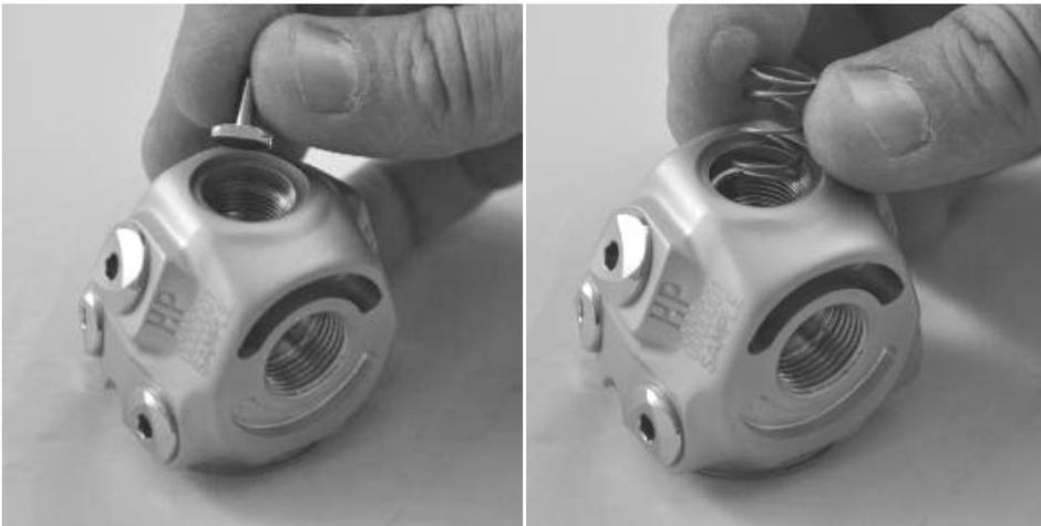
6. Coloque uma chave Allen de 8 mm no bujão (129604/129709/129746). Encaixe o bujão no corpo do regulador. Empurre o bujão para comprimir a mola, ao mesmo tempo enroscando o bujão no corpo até bloquear. Usando uma chave de torque, aperte o bujão a 0,5 m.Kg.
