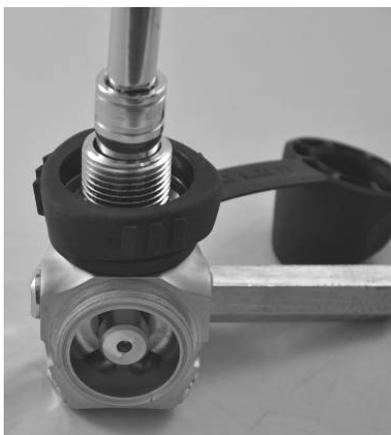
f. Encaixe a mola (129204) em torno do parafuso DIN ACD e coloque a coroa do obturador com seus O-rings.
