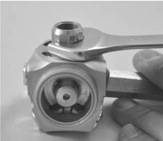
Se o suporte do filtro permanecer no parafuso DIN, desparafuse usando uma chave de fenda de 17 mm segurando o parafuso DIN com um soquete de 7/16”.
