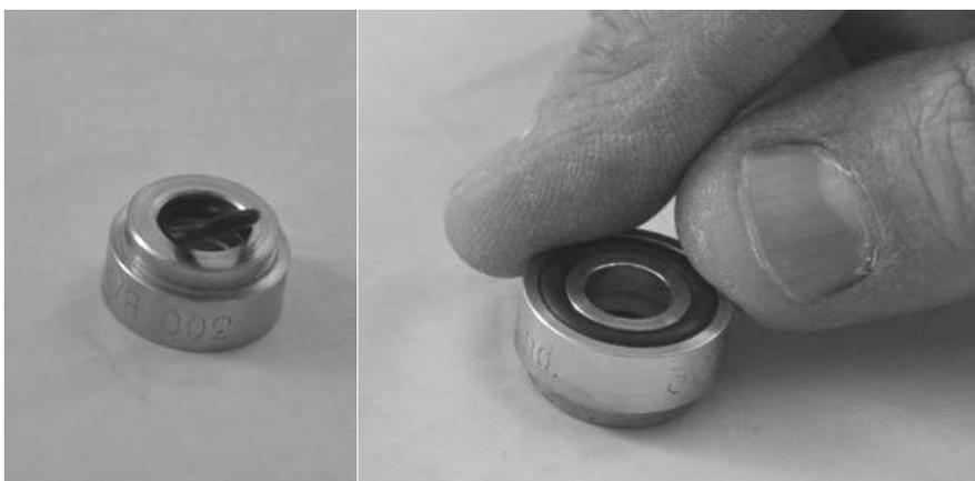
b. Encaixe um novo O-ring NÃO lubrificado (124703) dentro do suporte do filtro (129214) e depois encaixe o filtro (129209).
