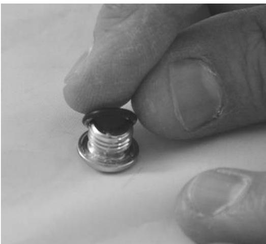
2. Coloque um novo O-ring lubrificado (124704) no assento (127585). Deslize o assento na ferramenta 116236, com a coroa de vedação do assento contra a parte plástica da ferramenta. Empurre o assento para dentro do corpo para posicioná-lo. Empurre a parte plástica atrás da ferramenta para verificar se está em contato.
