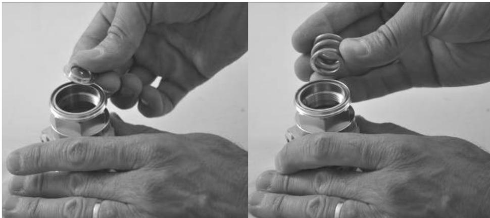
11. Coloque a arruela (127568) no parafuso de ajuste (127566). Coloque-o na mola. Usando uma chave Allen de 8 mm, aperte o parafuso de ajuste (127566) na câmara seca, até que uma rosca do parafuso ainda esteja visível.
