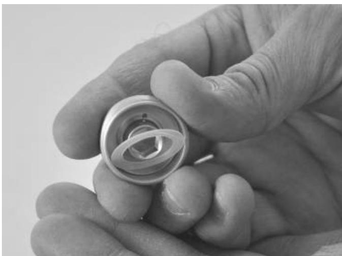
6. Parafuse a ferramenta de fixação 116230 na porta livre da HP. Prenda a ferramenta em um torno de modo que a câmara seca (129602) seja posicionada na parte superior. Use uma chave de boca plana de 32 mm para desparafusar a câmara seca do corpo. Remova a almofada de mola (127565) e o diafragma (119159). Retire o corpo do torno.
