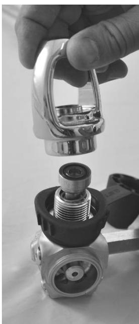
h. Aperte a válvula do obturador DIN (129202/129714/129207) até 0,3 m.Kg ( Allen 4 mm).
