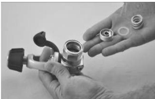
**NOTA:** A arruela pode grudar na parte interna do parafuso de ajuste. Se isso ocorrer, bata levemente com o parafuso na palma da mão para soltá-lo e deixar a arruela cair.
