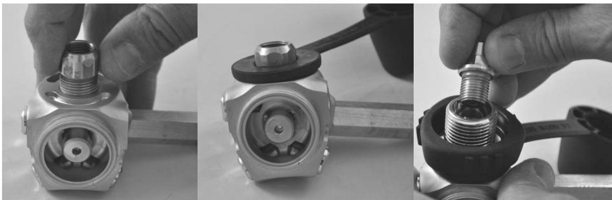
e. Usando uma chave de torque (com a ferramenta 7/16”), aperte o parafuso DIN ACD até 2,5M.Kg.
