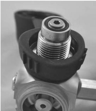
j. Remova o regulador do torno, remova a ferramenta e encaixe um bujão HP com seu novo O-ring lubrificado.
