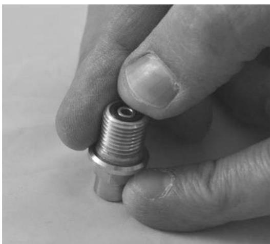
d. Enrosque o suporte do filtro (129214) no corpo. Deslize a tampa DIN (129608) e o volante DIN (129619/129722) e parafuse o parafuso DIN ACD (129213) dentro do suporte do filtro.
