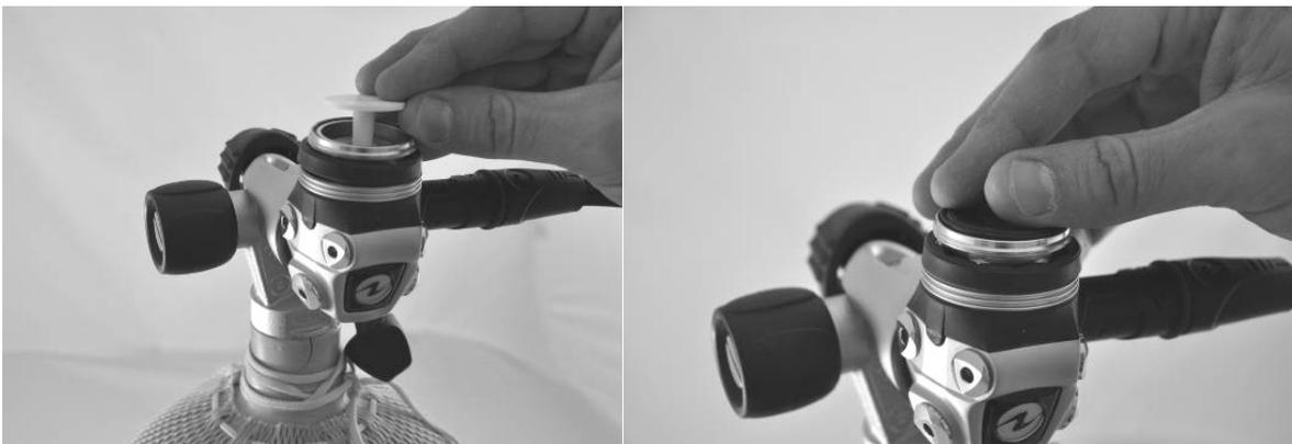
3. Com uma chave de torque Allen 8 mm, aperte o bujão da câmara seca (129604/129709/129746) pela parte superior até 0,4 m.kg. Verifique se o IP ainda está em 8,5 bar.
