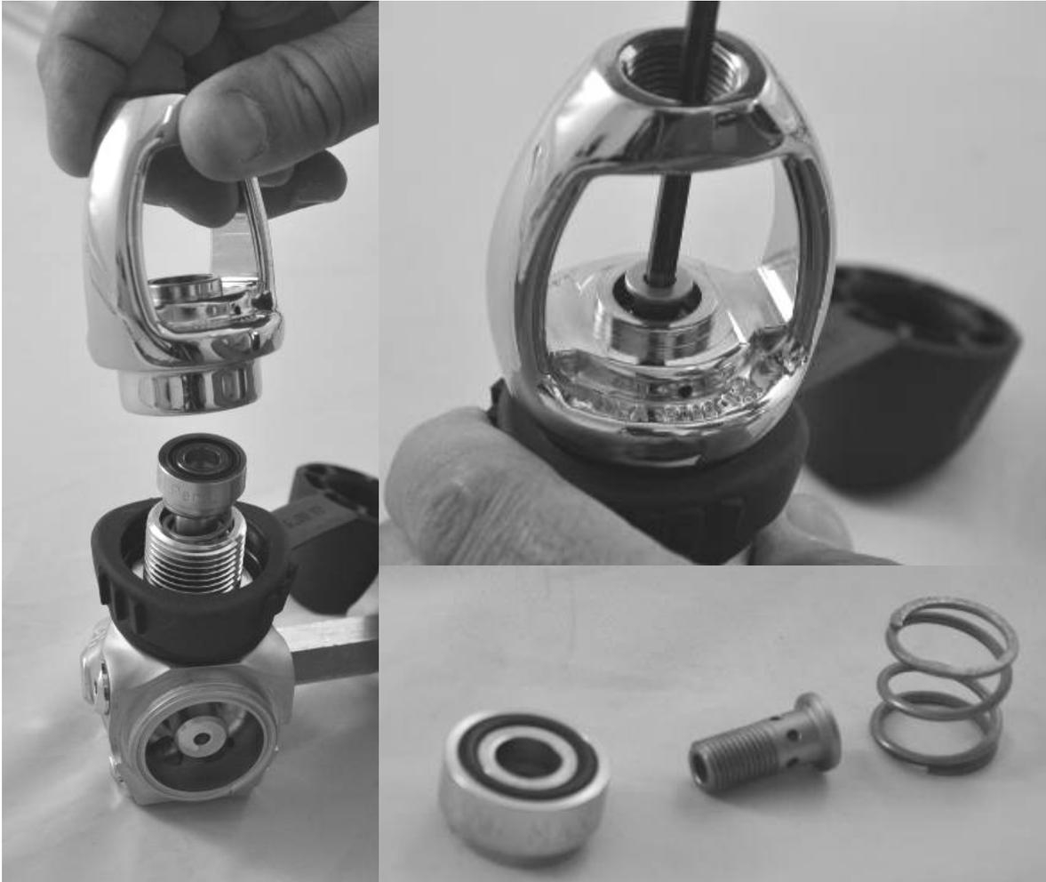
b. Usando um soquete 7/16", remova o parafuso DIN (129213).
