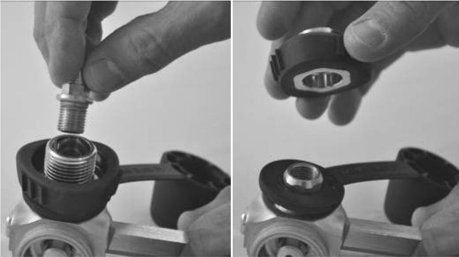
d. Use uma chave de boca de 17 mm para desparafusar o suporte do filtro (129214).
