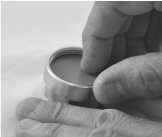
9. Parafuse a ferramenta de fixação 116230 em uma porta HP e prenda a ferramenta em um torno com o diafragma para cima. Enrosque a câmara seca (129602) totalmente no corpo com a mão. Coloque a ferramenta 122152. Usando uma chave de torque, aperte a câmara seca a 2,5 m.kg.
