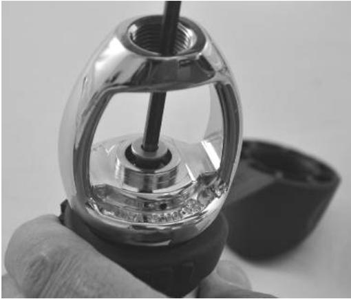
i. Remova o adaptador Yoke do volante.
