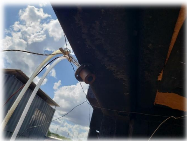
Figura 4-60 – Alocação do sensor de fluxo de calor ( Schmidt-Boelter ).
