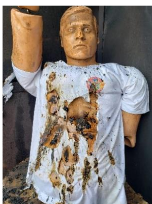
Figura 4-88 – Gotejamento de resíduos incandescentes numa camisa.
