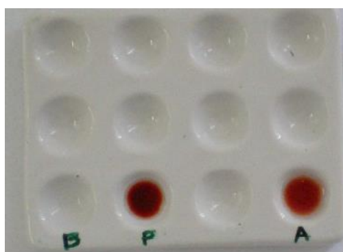
Figura 4-87 – Teste de detecção de cianeto.
