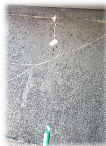
Figura 4-61 – Alocação do termopar, acima da Chuva de Prata.
